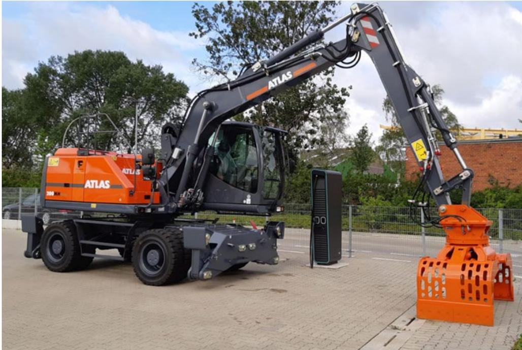
Abbildung 1: Ladeinfrastruktur für schwere Nutzfahrzeuge (E-Bagger, Abfallsammelfahrzeuge), Stadtreinigung Hamburg
