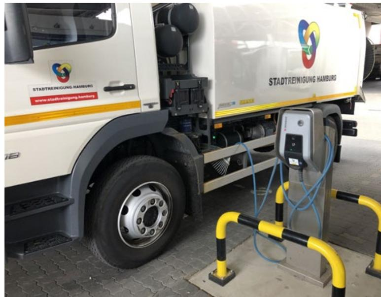
Abbildung 2: Teilelektrifizierte Kehrmachine, Stadtreinigung Hamburg
