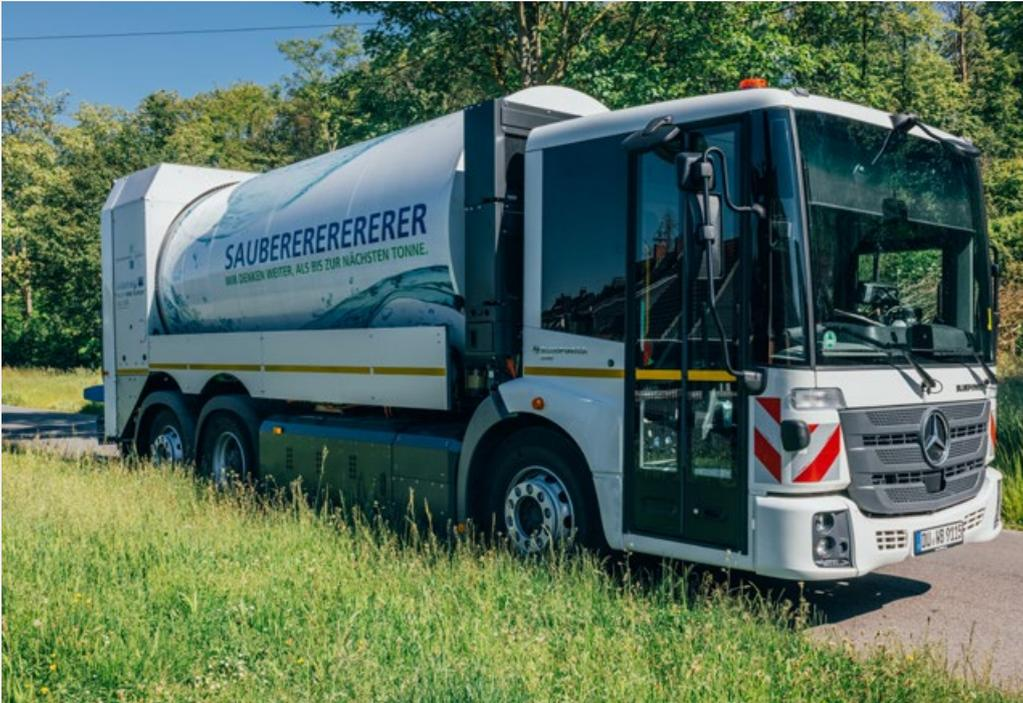
Abbildung 8: Brennstoffzellenfahrzeug Duisburg, © Dominik Asbach
